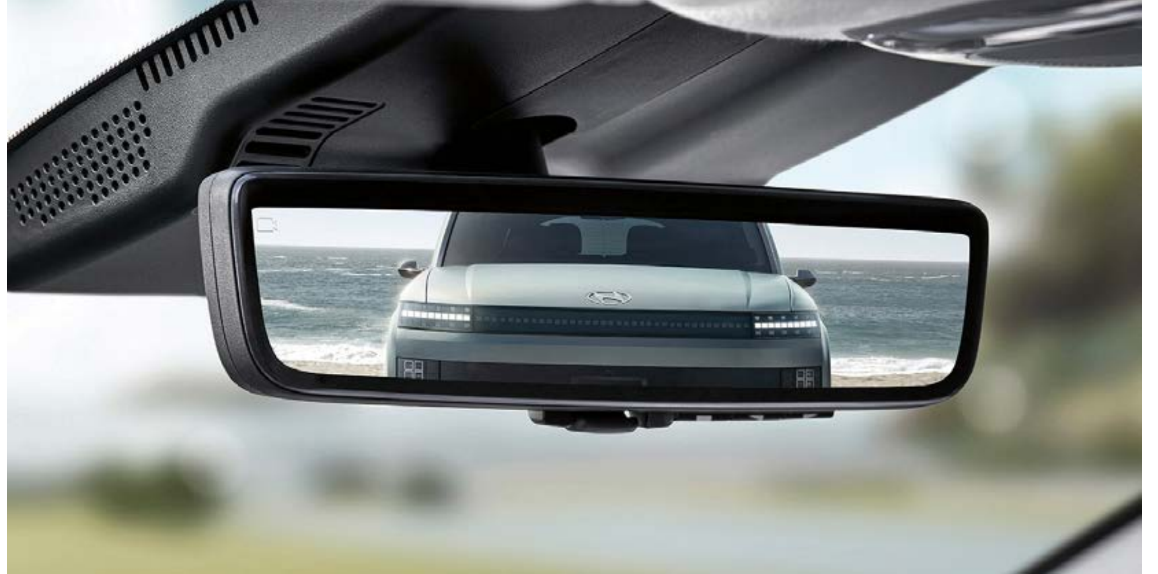
Dijital Dikiz Aynası, etkinleştirildiğinde arkada bulunan kamera yardımıyla aynaya gerçek zamanlı video yansıtır ve çok daha geniş bir görüş alanı sunar.
