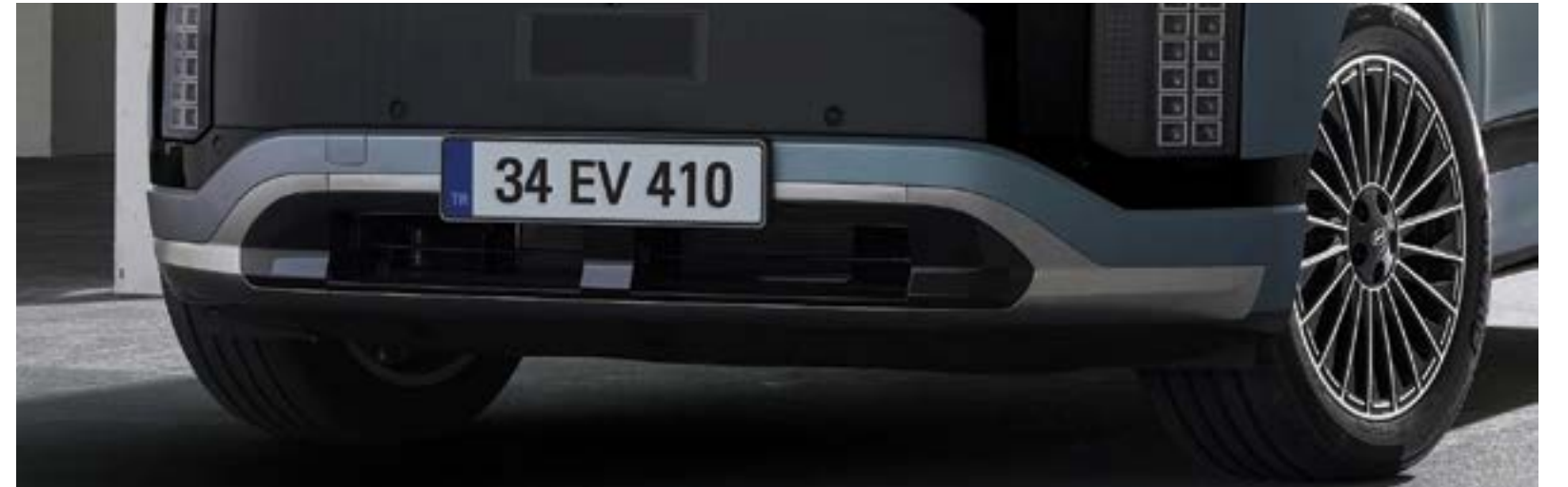
Daha iyi aerodinamik performans ve daha şık görünüm için çift yönlü aktif kava kapakçığı sistemi.
