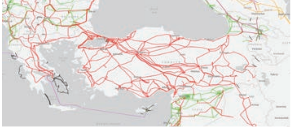
Şekil 16. Türkiye 400kV elektrik iletim sistemi 26
