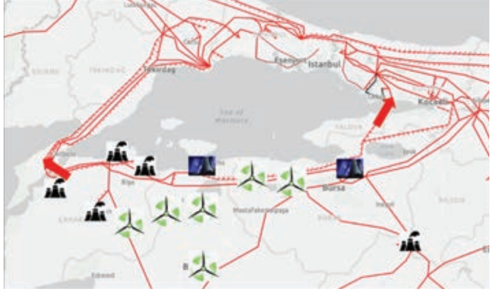
Şekil 25. Planlanan yeni YG denizaltı hatlarındaki elektrik akışı
